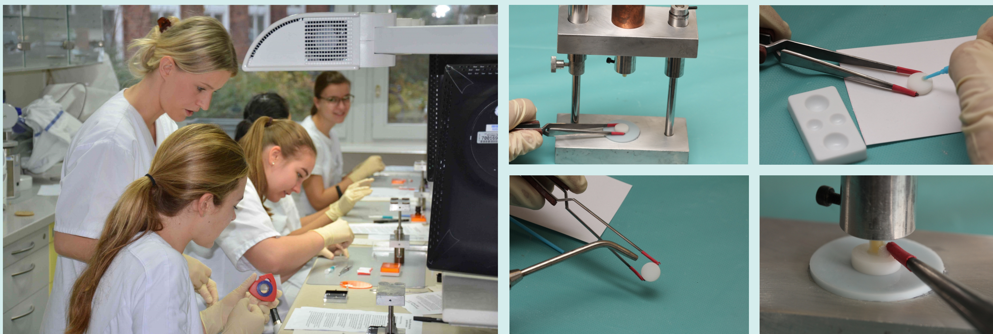
Abb.1 Durchführung der Verklebung im vorklinischen Kursraum (links) und standardisierte Verklebevorrichtung mit beispielhaften Einzelschritten der Verklebung (rechts)
